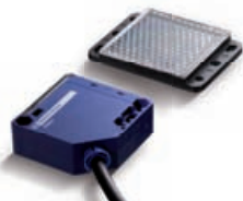
Reflexivní světelná závora Extra 628 • 24-240 V AC, 12-240 V DC, IP 54 • dosah 5 m • lze použít pouze jako vysílač impulzů
