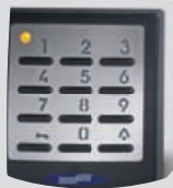
Bezdrátová kódovací klávesnice Signal 218 10 kódů, 433 MHz, plovoucí kód KeeLoq s nerezovou clonou, podsvícená
