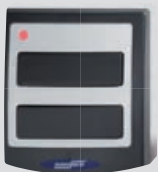
Bezdrátová interiérová klávesnice Signal 111 2 kanálová, 433 MHz, plovoucí kód KeeLoq- pro ovládání 2 pohonů nebo 1 pohonu a 1 venkovního osvětlení
